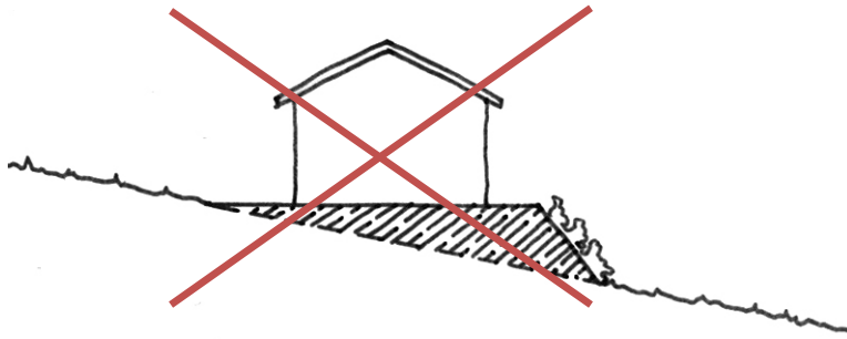
la mise à niveau par talutage
