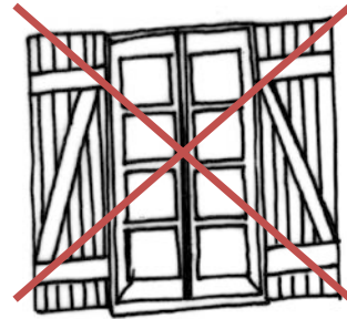
volets à écharpe dit « Z »
